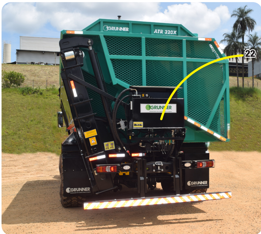
Figura 7-1 – Reservatório de Óleo Hidráulico
