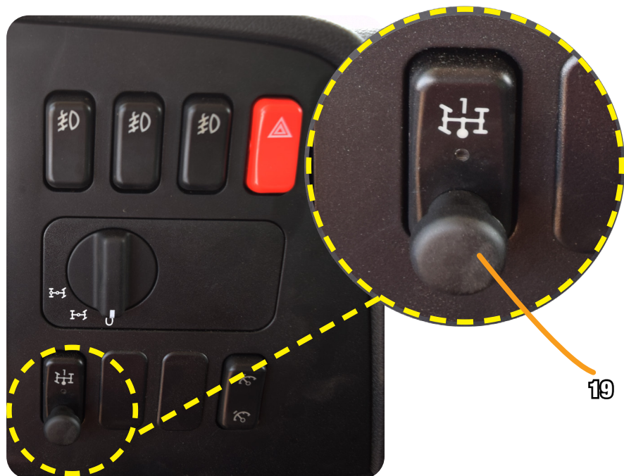
Figura 7-26 – Botão de Acionamento da Bomba Hidráulica
