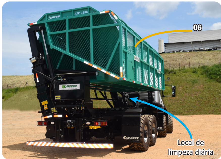
Figura 8-8 – Região de Limpeza entre a Caixa de Carga e o Chassi
