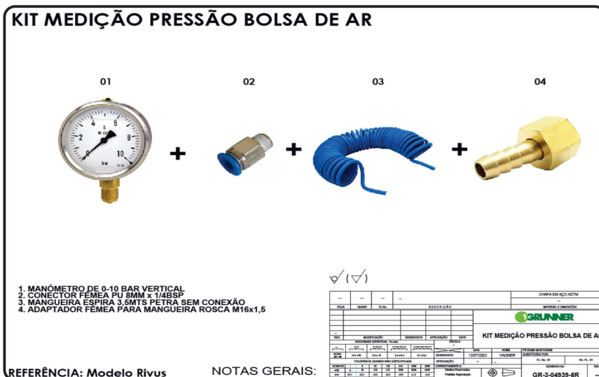
Figura 8-19 – Kit medição de Pressão
