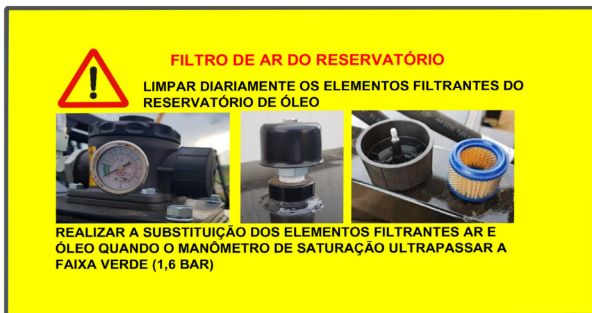
Figura 2-4 – Inscrição Técnica – Filtro de Ar do Reservatório (75) Localizada no Reservatório de Óleo do Transbordo
