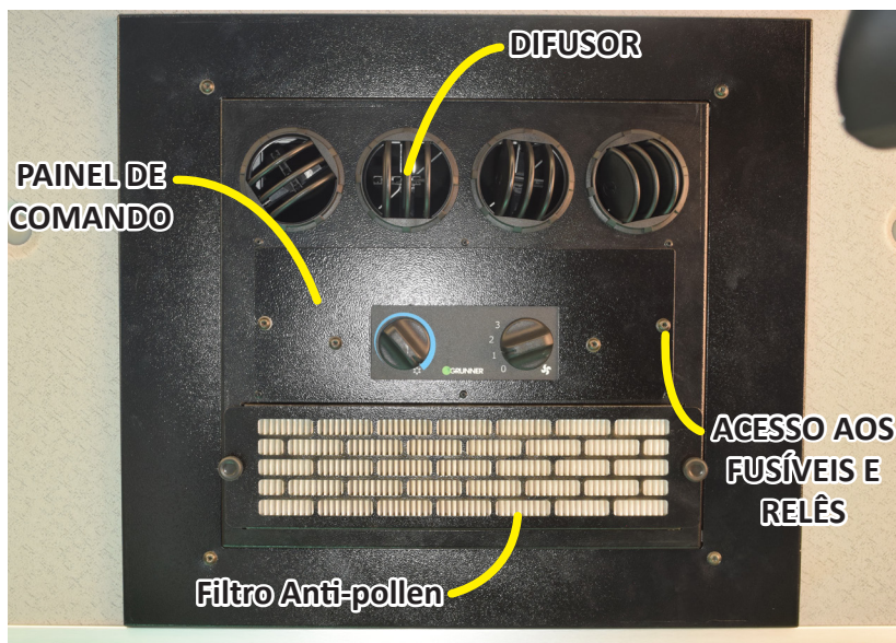
Figura 8-28 – Painel de Ar-Condicionado
