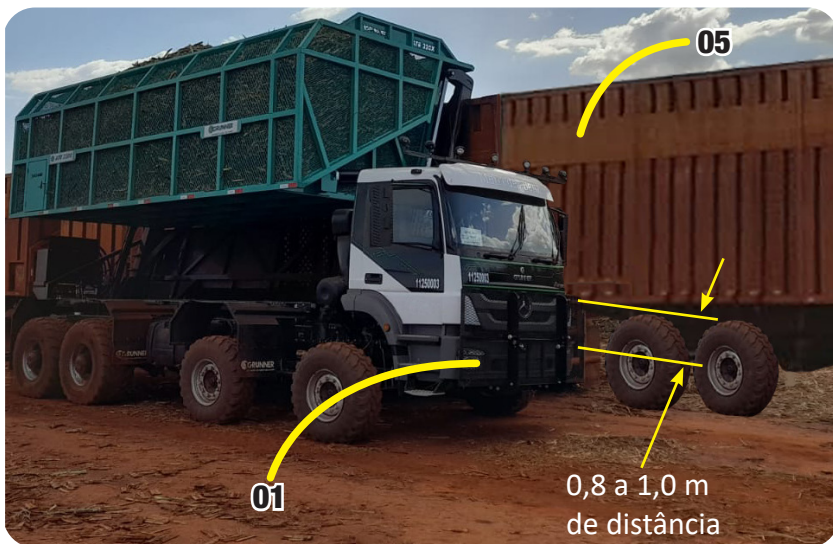
Figura 7-25 – Transbordo Autopropelido alinhado ao lado do Caminhão Reboque Canavieiro
